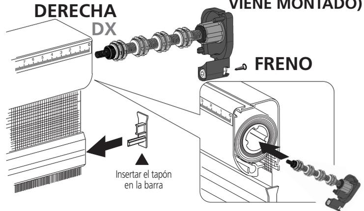
El freno se suministra ya regulado para el normal funcionamiento de la mosquitera. A pesar de ello, es posible regular la velocidad de recogida de la mosquitera.
