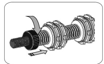
Girando en sentido horario la pieza mostrada, la velocidad de recogida disminuirá.
